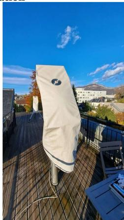
Télescope en home position, housse de télescope étanche qualité marine
