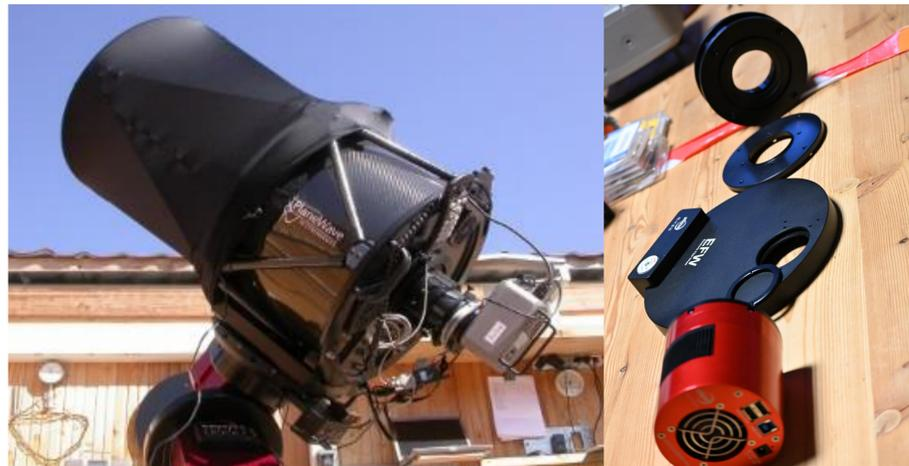
Télescope robotisé et fonctionnant en remote
